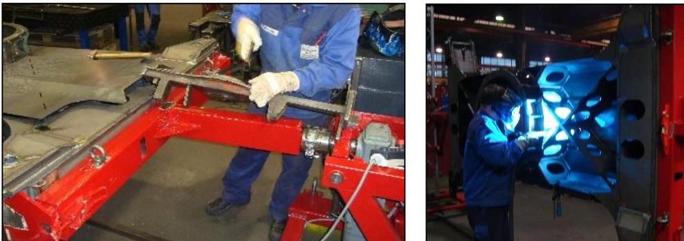
*Abbildung 4: Einsatz der geplanten Hub- und Wendevorrichtung zur Reduktion physischer Belastung bei einer Fahrgestellmontage*
